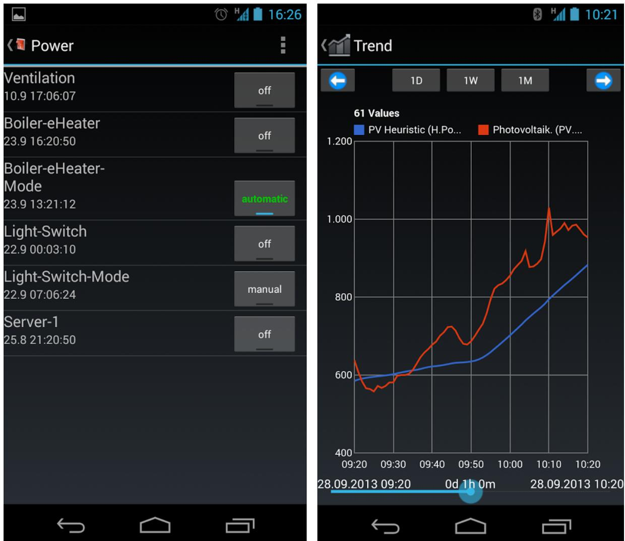
Abb. 19) Mobile-App Bedienoberfläche für die Steuerung und Trenddarstellung
