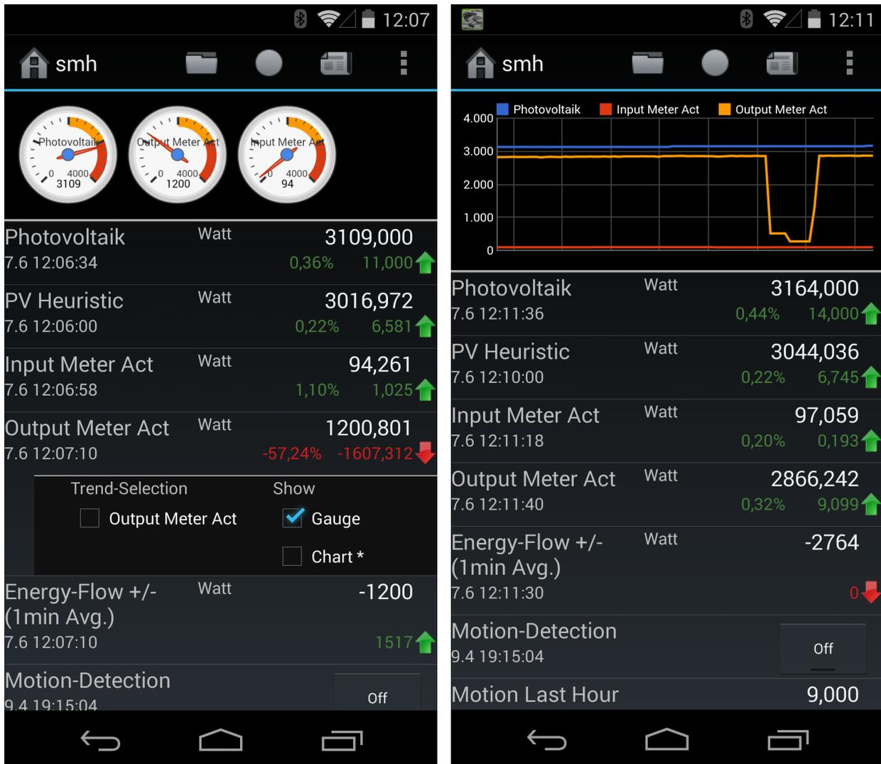
Abb. 20) Mobile-App Bedienoberfläche für die Visualisierung und integrierter Trenddarstellung
